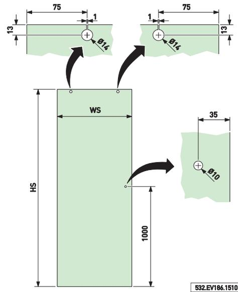
Die Glasbohrung mit dem Durchmesser von 10 mm ist nur bei Verwendung des Aquant-Griffs vorzunehmen.
