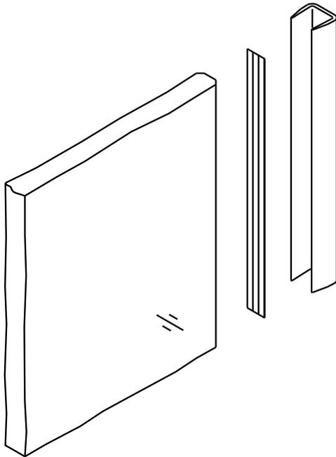
Das Glaskantenschutzprofil aus transparentem Kunststoff wird mit dem doppelseitigen Klebeband auf die Glaskante geklebt.
