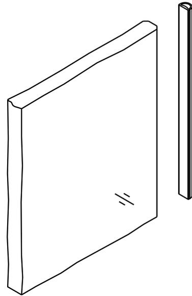
Das selbstklebende Gummiprofil in schwarz oder transluzent reduziert die Zugluft auf ein Minimum und schützt die Glaskanten.
