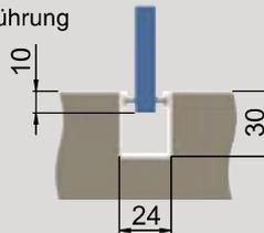
Wir empfehlen bei Montage mit Deckenabhängung bei Einsatz von Rolle und Aushängesicherung eine durchgehende Bodenführung bedingt durch die außermittige Lagerung der Schiebetür.
