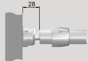
Die Verbindungsstange ist bei Einsatz der Sicherheitsanbindung um 28 mm zu kürzen.
