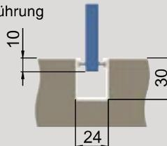
Wir empfehlen bei Montage mit Deckenabhängung bei Einsatz von Rolle und Aushängesicherung eine durchgehende Bodenführung bedingt durch die außermittige Lagerung der Schiebetür.
