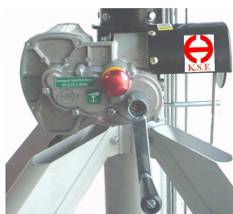
Hand-Betrieb bei Stromausfall durch eine Handkurbel
