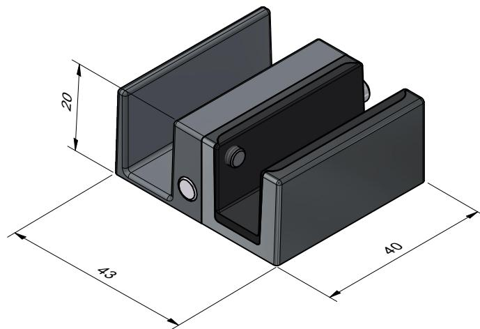
Bodenführung mit Seitenteilaufnahme
