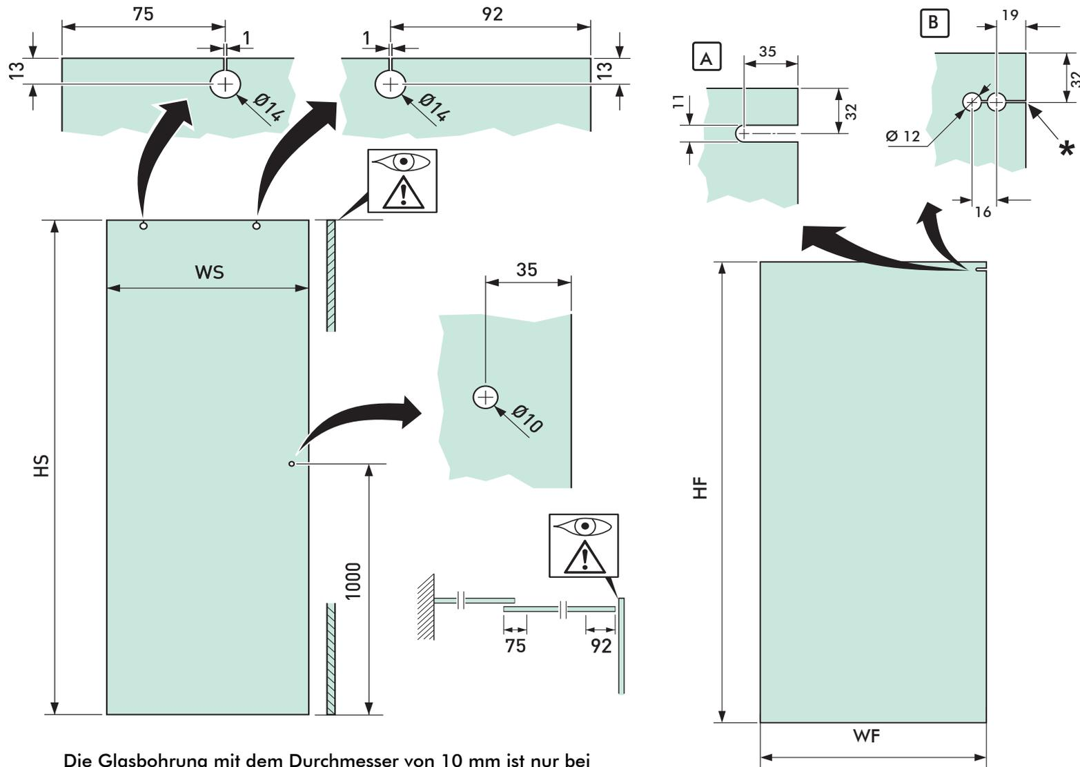
Die Glasbohrung mit dem Durchmesser von 10 mm ist nur bei Verwendung des Aquant-Griffs vorzunehmen.
