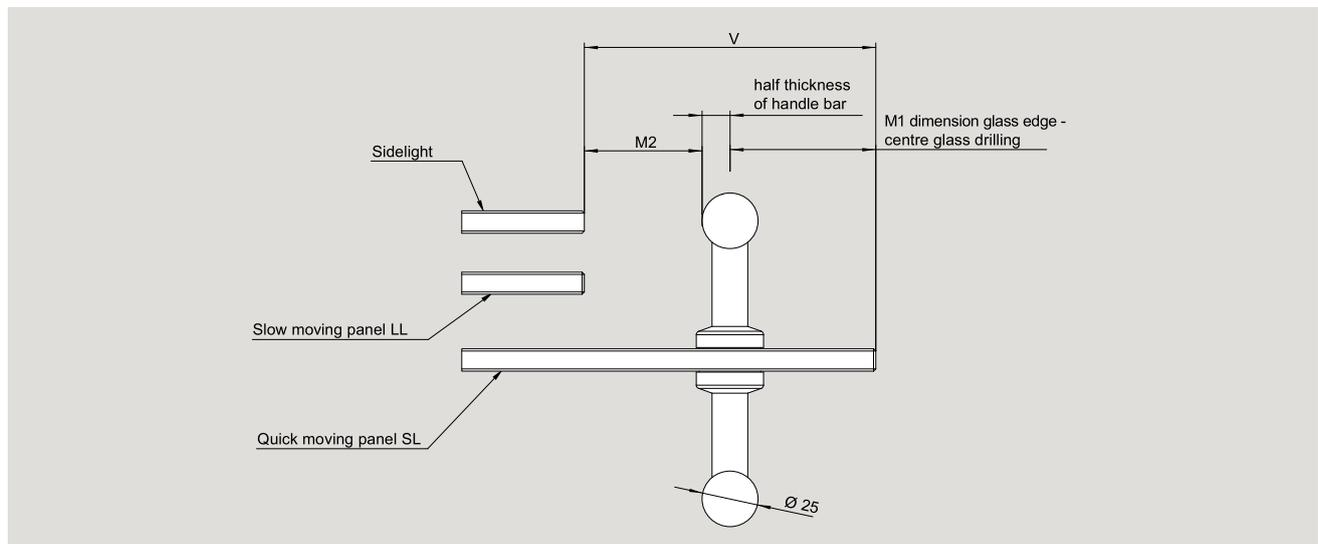
V = Überstand des Schnellläufers bei Anwendung mit Griffstange
