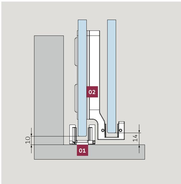
Glasbearbeitung für mitfahrende Bodenführung am Langsamläufer (am Beispiel DIN Rechts / Links öffnend)
