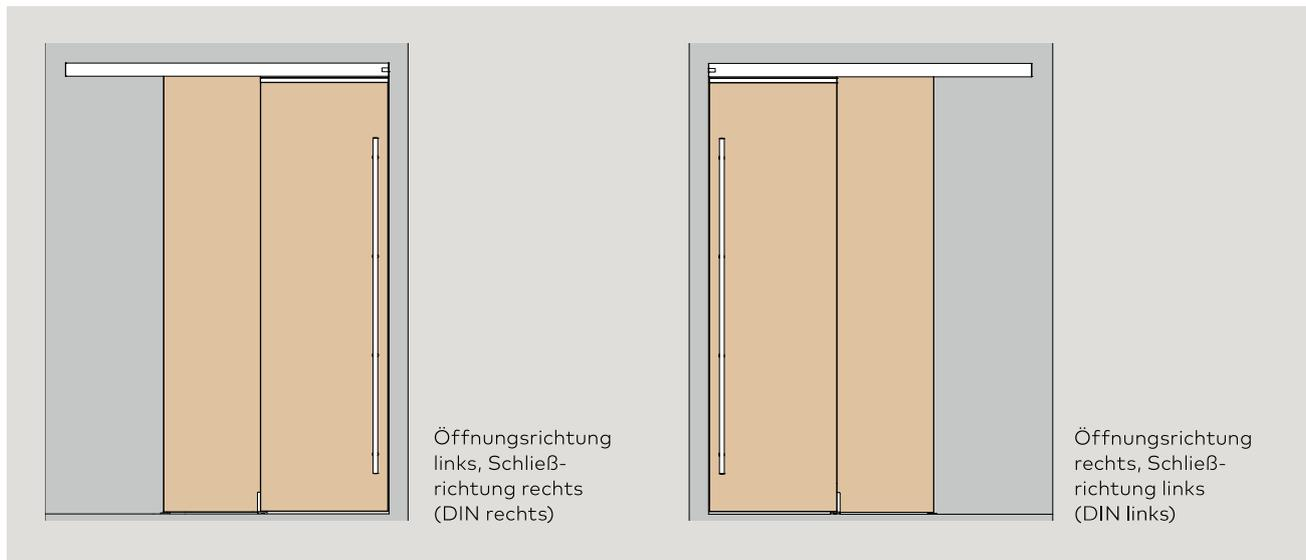
Öffnungsrichtung links, Schließrichtung rechts (DIN rechts)
