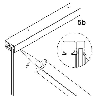
Trockenverglasung mit dem Hawa-Gummiprofil
