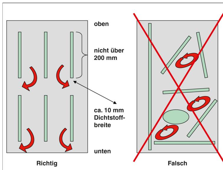
Zur Vermeidung der Einsperrung des Vernetzer-Spaltprodukts ist ein Mindestabstand zwischen Spiegel und Untergrund von 1,6 mm zwingend einzuhalten. Dieser lässt sich auf zweckmäßigste Weise durch das Aufkleben von Abstandshaltern erreichen. Der hier vorgeschriebene Mindestabstand dient dem Abtransport des Vernetzer-Spaltprodukts. Damit werden die vom Institut des Glaserhandwerks in Hadamar geforderten Mindesthinterlüftungsabstände für Spiegel in keinem Fall aufgehoben.
